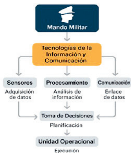
Figura 2. Estructura de sistema C-2 militar asistido por TIC. Fuente: Propia del autor.
