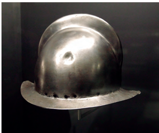
Casco para ir a la guerra y «a prueba» del disparo de mosquete, que recuerda el interés de los grandes señores por adquirir la mejor tecnología y cómo los armeros demostraban la calidad de sus trabajos a los compradores con fuego real, como refleja la abolladura de la pieza.
