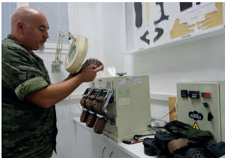
Las botas del combatiente se someten a torsiones inimaginables y otras pruebas de calidad para comprobar su resistencia.
