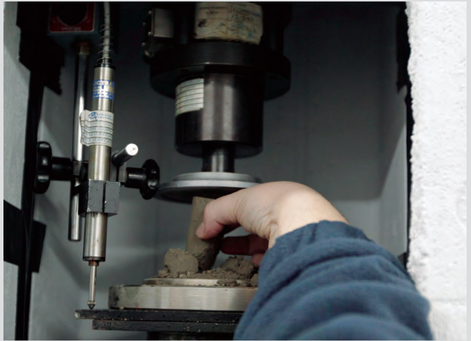
El busto del general José Marvá preside la entrada al centro. Arriba, rotura a compresión de muestras recogidas en la Antártida.
